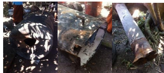
Gambar 3. Sisa-sisa boiler yang meledak
