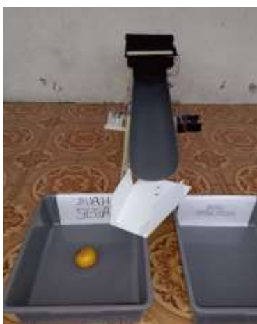
Gambar 9. Motor Servo saat menempatkan buah jeruk segar
