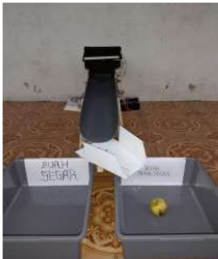
Gambar 12. Motor Servo saat menempatkan buah apel tidak segar
