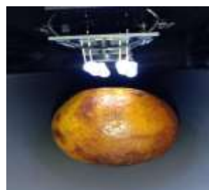
Gambar 6. Sensor warna tcs3200 saat mendeteksi buah jeruk tidak segar
