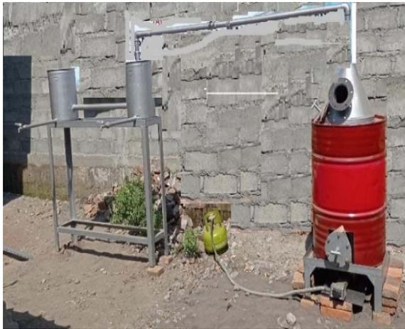
Gambar 1. Desain Mesin Pirolisis Konsep A
