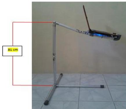
Gambar 3: Desain Alat Stand Laptop Tampak Samping Posisi Duduk
