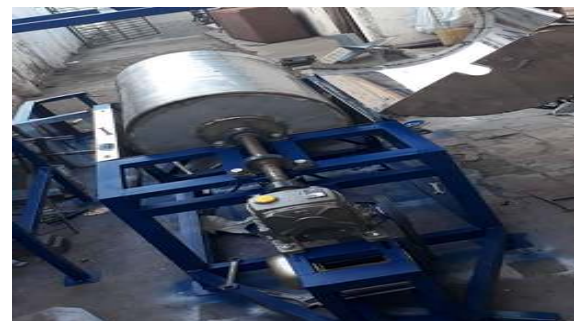
Gambar 2. Mesin Sangrai Krupuk Pasir. Bahan Drum SS304 Dengan Tebal 3mm
