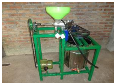
Gambar 3. Alat pembuat pasta bawang
