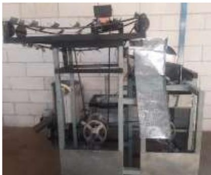
Gambar 2. Alat Pemotong Daun Bawang Merah
