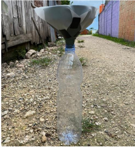
Gambar 6. Alat Filtrasi Air Sumur Tanah Tampak Depan
