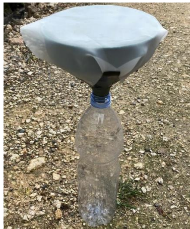
Gambar 7. Alat Filtrasi Air Sumur Tanah Tampak Atas
