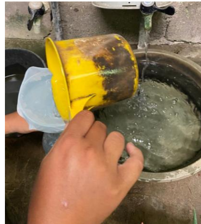
Gambar 9. Proses Filtrasi Air Sumur Tanah Dengan Kain Screen Monyl T54
