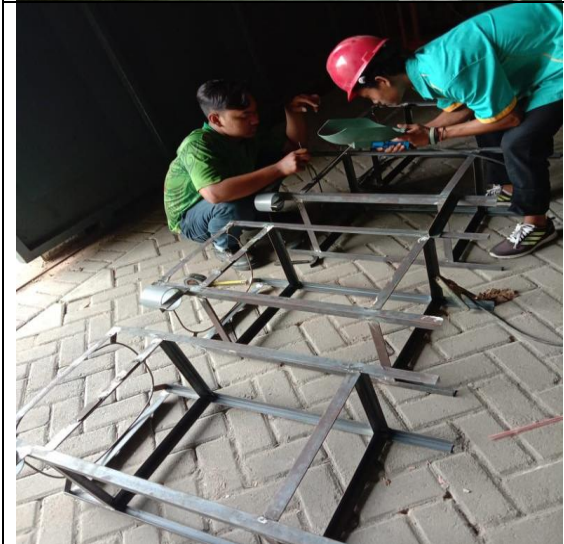
Gambar 4. Kerangka alat cuci tangan
