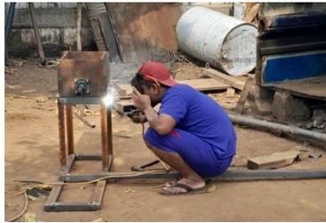
**Gambar 7.** Pembuatan Rangka Alat
