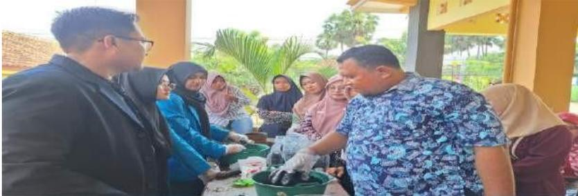
Gambar 9. Proses mencampur dan mengaduk arang pelepah siwalan dengan tepung tapioka yang sudah dicairkan dengan air panas
